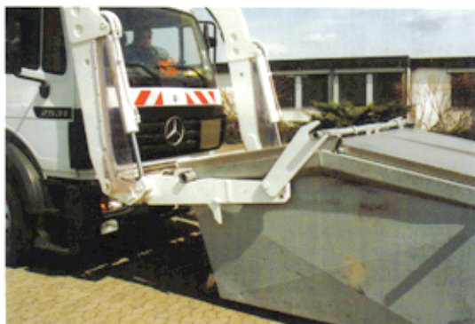
Die U-5 Aufnahme ist ausklappbar in die Aufnahmeabeln integriert. Die U-5-Behälter können ohne zusätzliche Umrüstarbeiten gefahren werden. Ausstattung auf Wunsch.
