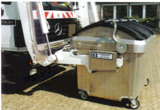
Automatische und sichere Gabelaufnahme der DIN MGB 2,5 und 4,5 sowie FLB 2,5 und 4,5 im Ein-Mann-Betrieb.
