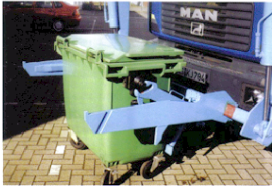
Ausklappbare Zapfenaufnahme für MGB 0,7 und 1,1 Behälter mit Klappdeckel
