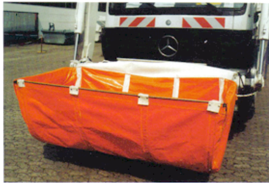
Der Aufnahmesack, z. B. für DSD- oder Sackabfuhr, kann zusammengelegt am EcoPack 30 mitgeführt werden und problemlos in die Aufnahmeabeln eingehängt werden.
