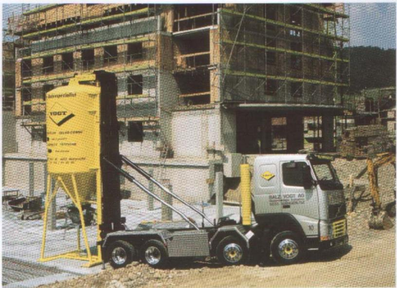
Silo interchangeable à deux cellules pour aire en ciment
