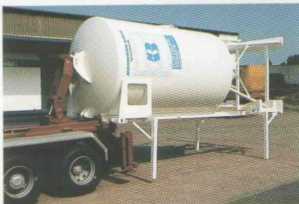
Wechselsilo WS (D) 22,5 für Bahntransporte nach UIC-Norm und Straßentransporte
