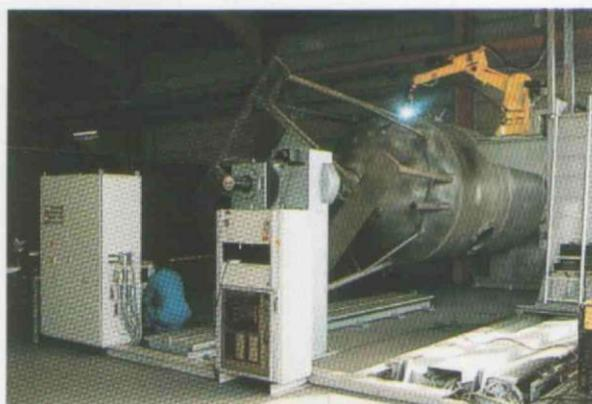
Robotereinsatz bei der Silofertigung
